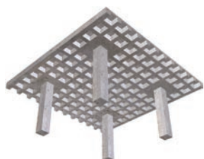
Losa bidireccional c/capiteles macizos
